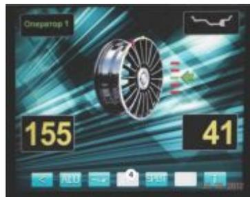
14.3. После запуска станка и получения результата измерения дисбаланса оператор оценивает необходимость разделения груза на правой стороне диска. Если место установки балансировочного грузика окажется между спицами, то с помощью программы Split можно его разделить и установить за спицами.
