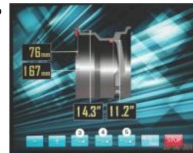
до появления звукового сигнала. Станок автоматически определит программу ALU 3 и появится соответствующий экран ввода параметров рис.11.2.
