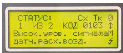
Рис. 10. Пример экрана при просмотре ошибок
