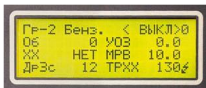
Рис. 17. Вид экрана прибора при управлении реле бензонасоса
