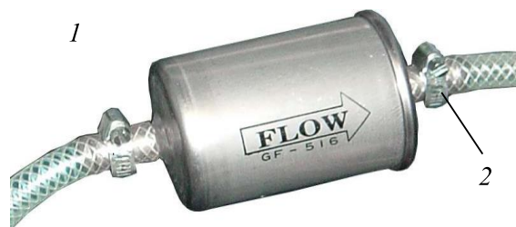
Рис. 11. Фильтр тестирующей жидкости: 1,2 – крепежные хомуты.
