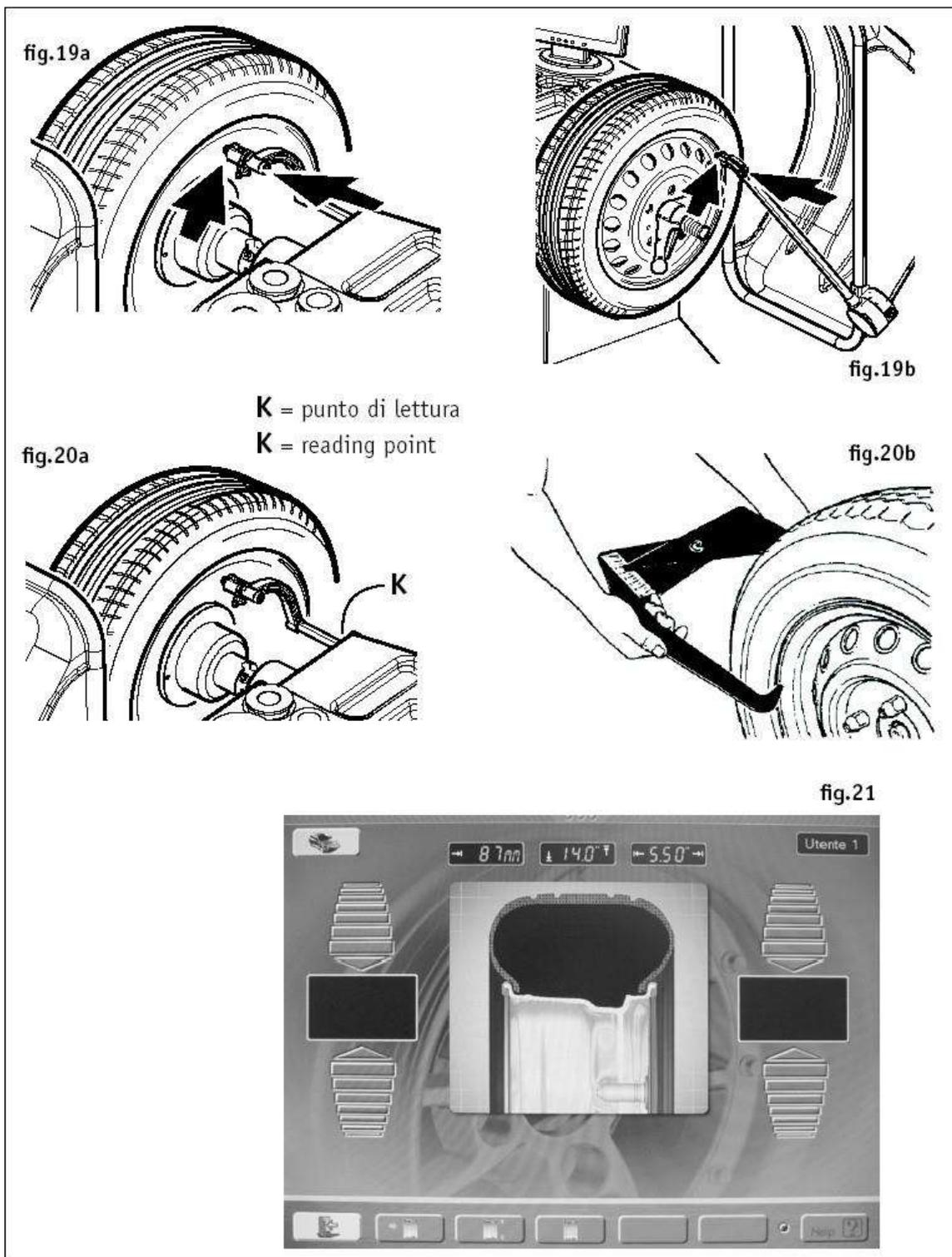
Программирование выполняется подводом **внутренней мерной линейки (рис.19а)** и **внешней мерной линейки (рис.19b)** вплотную к ободу, до появления звукового сигнала подтверждения “бип”.
