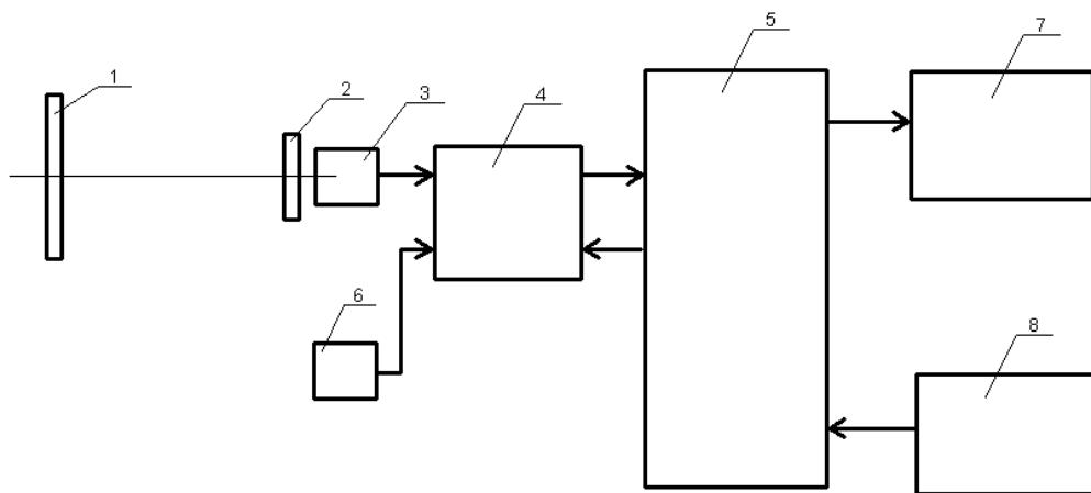
1 - Линза Френеля; 2 – Светофильтр; 3 – Фотодиод; 4 – Управляемый усилитель сигнала фотодиода; 5 - Электронная плата управления и индикации; 6 – Внешний фотоприемник; 7 – Двухстрочный индикатор; 8 – Кнопки управления.
