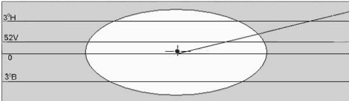
Рисунок 14 - Положение светотеневой границы пучка дальнего света
