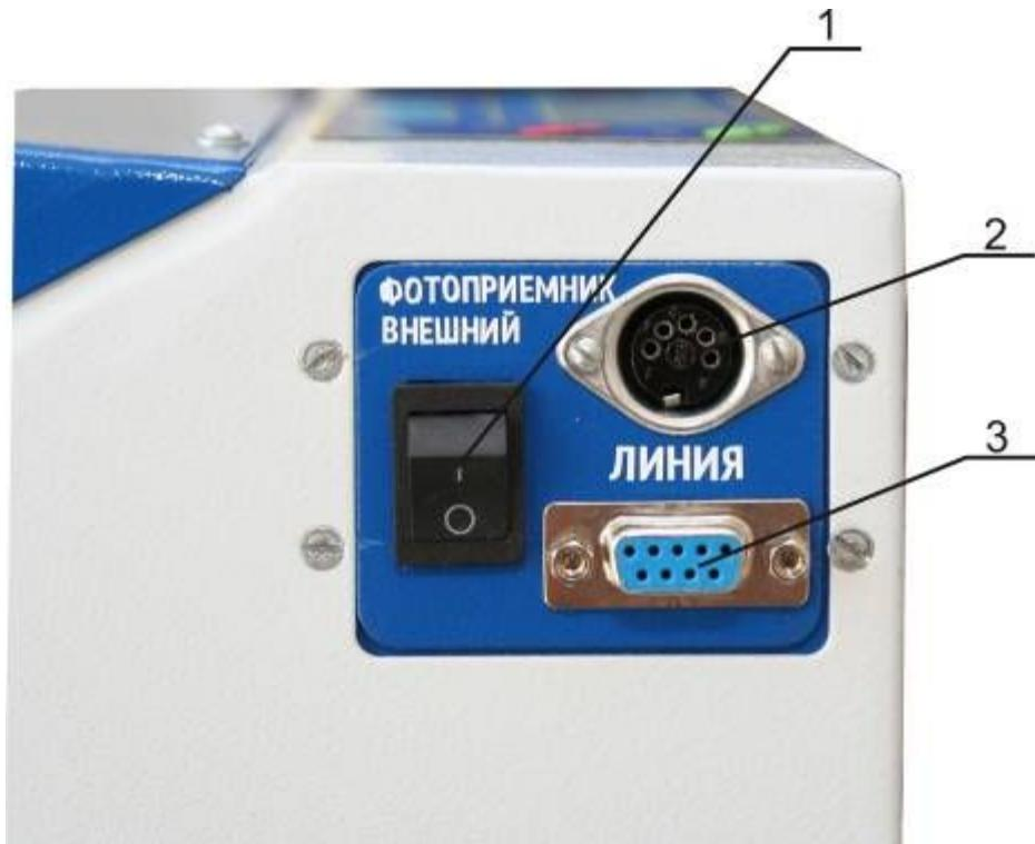
1 – Выключатель фотоприемника внешнего; 2 - Разъем подключения выносного датчика указателей поворота; 3 - Разъем для подключения линии диагностического контроля
