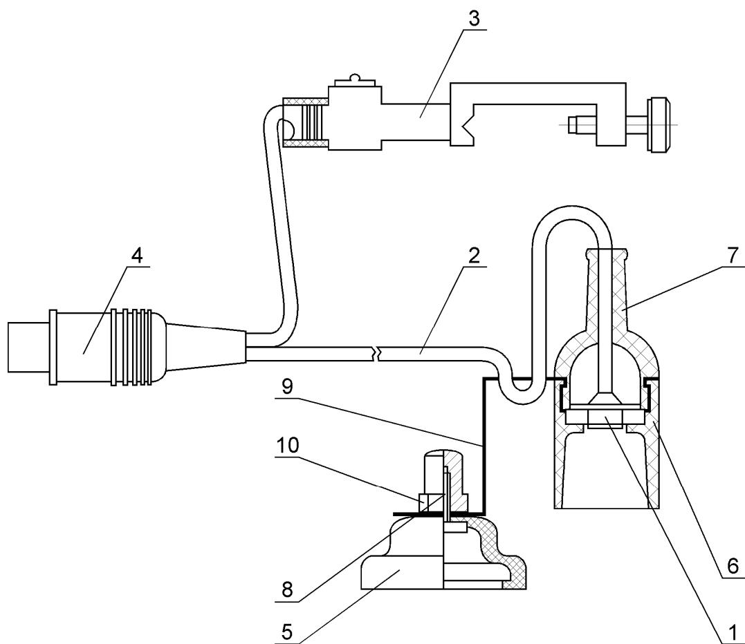
1-Плата фотоприемника; 2-Жгут; 3-Датчик указателя поворота; 4-Разъем для подключения к измерительному блоку; 5-Колпачок-присоска; 6-Корпус; 7-Крышка; 8-Винт; 9-Кронштейн; 10-Гайка
