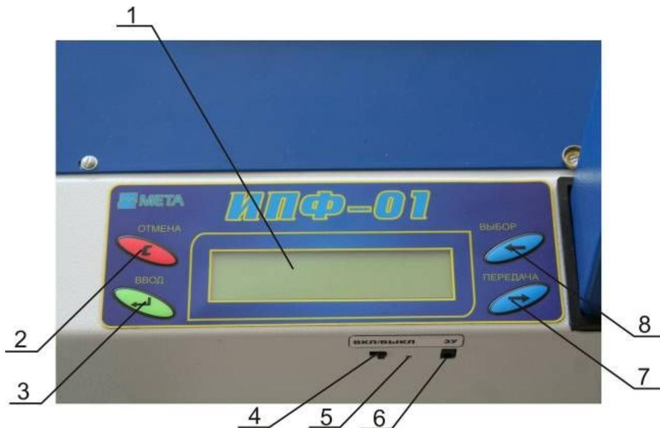
1 - Индикатор; 2 - Кнопка «ОТМЕНА»; 3 - Кнопка «ВВОД»; 4 – Выключатель питания прибора; 5 – Индикатор зарядки; 6 – Разъем для подключения зарядного устройства; 7- Кнопка «ПЕРЕДАЧА»; 8 - Кнопка «ВЫБОР»;
