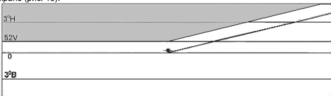
Рисунок 13 - Положение светотеневой границы пучка ближнего света
