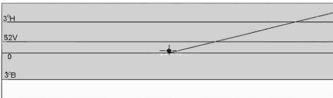
Рисунок 15 - Положение светотеневой границы пучка света противотуманных фар
