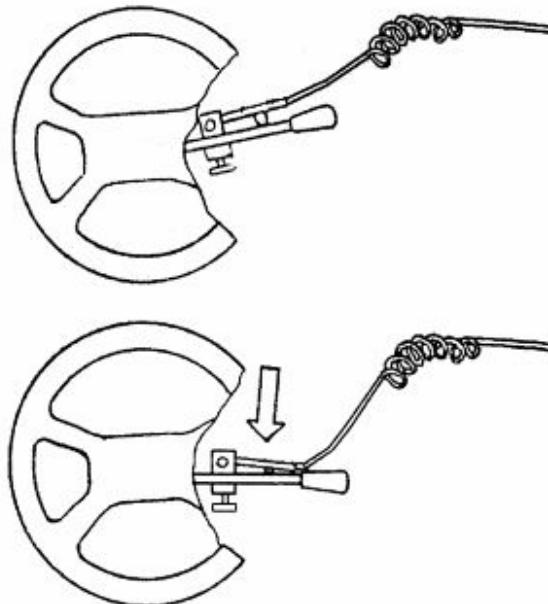
Рисунок 16 - Установка датчика включения указателей поворота
