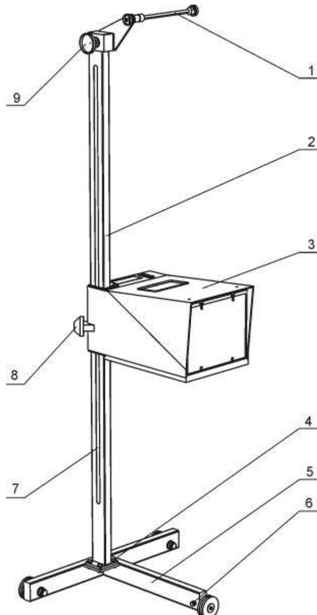
1-Оптический визир системы ориентации; 2-Стойка; 3-Измерительный блок; 4-Болт крепления стойки на площадке тележки (4 шт.); 5-Тележка; 6-Болт для фиксации уровня колеса; 7- Измерительная линейка для определения высоты установки проверяемой фары; 8-Маховик стопорения измерительного блока; 9-Винт крепления визира
