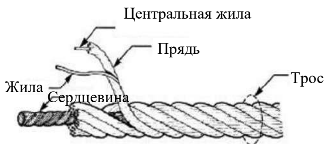
Три основных компонента стального троса
