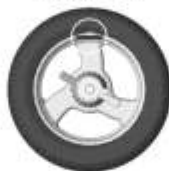
Рисунок 6.6 - Груз установлен в «12 часов»
