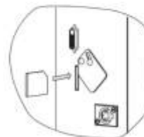
Рисунок 7.6 – Ориентация SD-карты при вставлении
