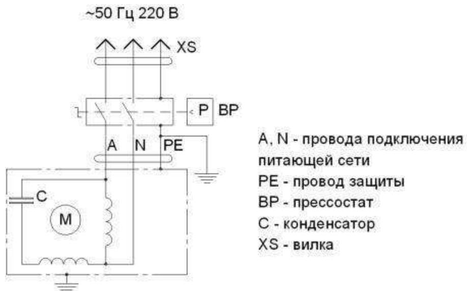
Рисунок А.1 - Схема электрическая принципиальная компрессоров СБ4/C-24.J1047B, СБ4/C-50.J1047B, СБ4/C-24.J1048B, СБ4/C-50.J1048B
