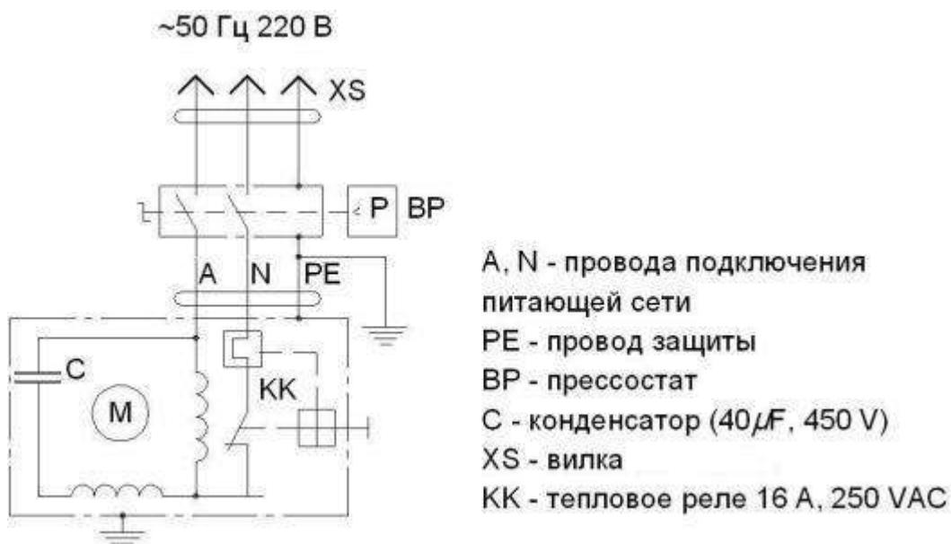
Рисунок А.2 - Схема электрическая принципиальная компрессоров СБ4/C-50.J2047B, СБ4/C-100.J2047B, СБ4/C-50.J2047BB, СБ4/C-100.J2047BB
