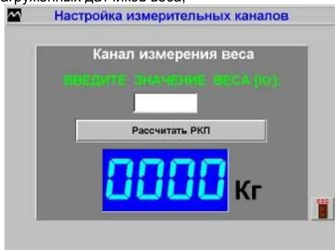
3) установить с помощью домкрата на индикаторе образцового динамометра значение, соответствующее задаваемому весу 1000 кг.
