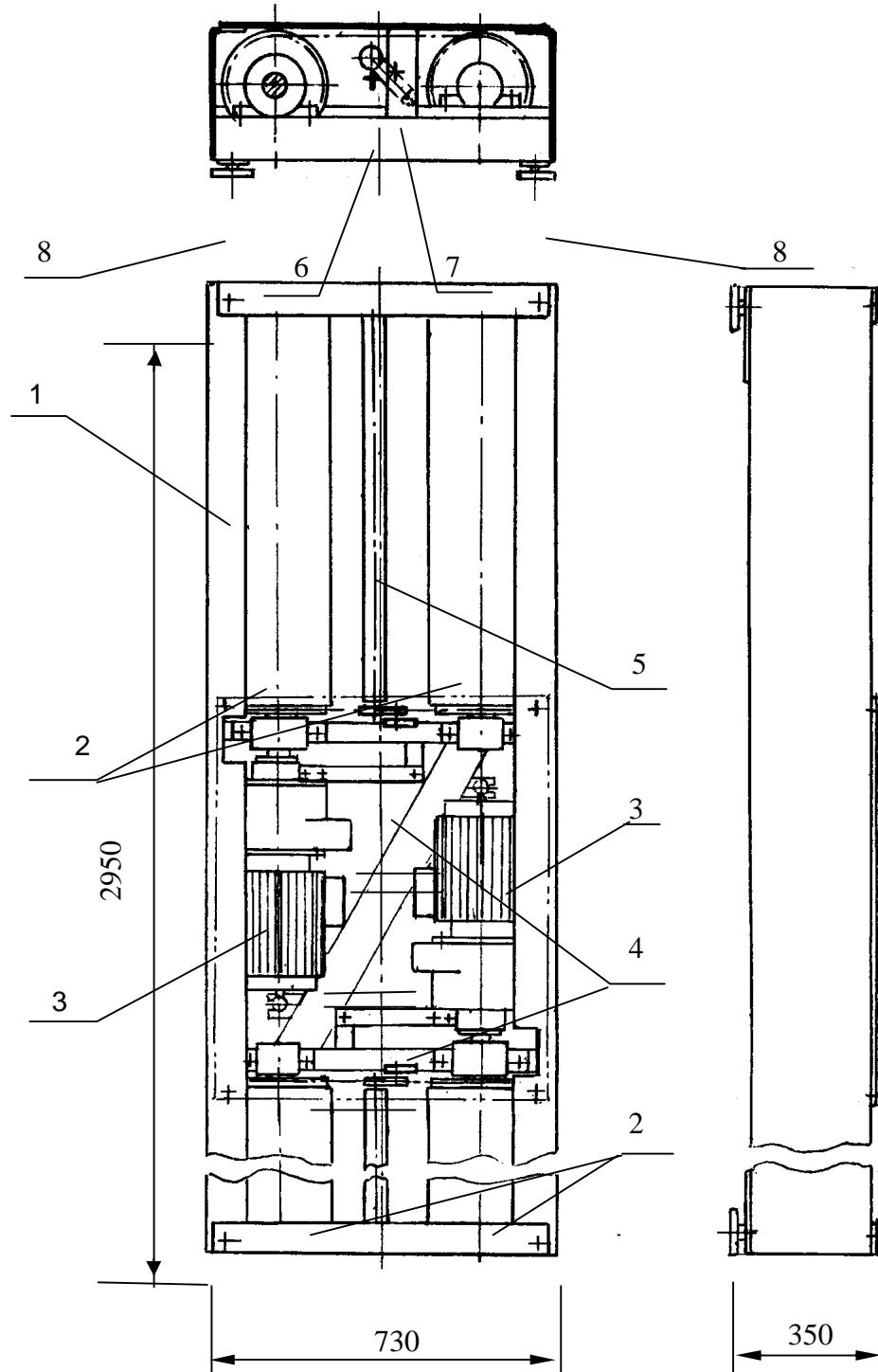
1-Основание; 2-Ролик опорный; 3-Привод; 4-Датчик тормозной силы;
