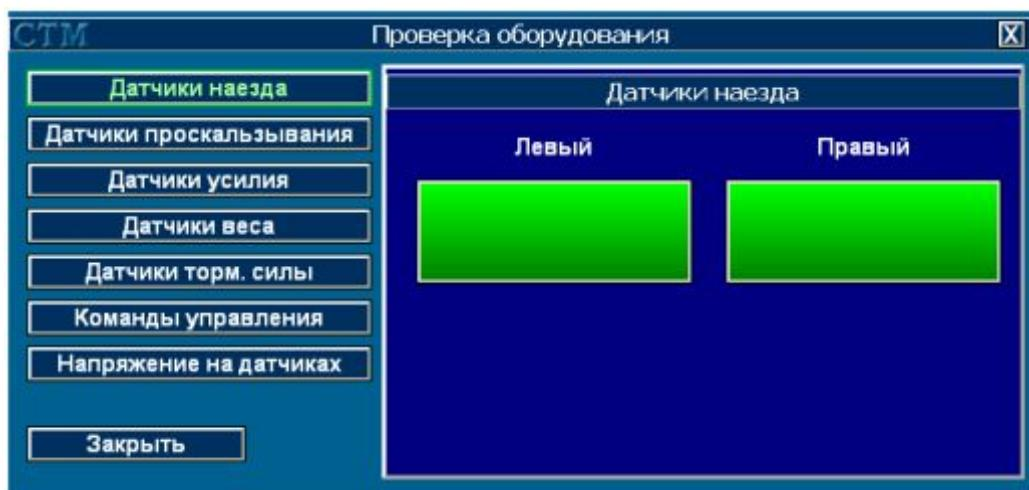
Красный цвет индикации означает, что данный датчик не задействован. При нажатии на следящий ролик, соответствующий сигнал должен измениться на зеленый, так:
