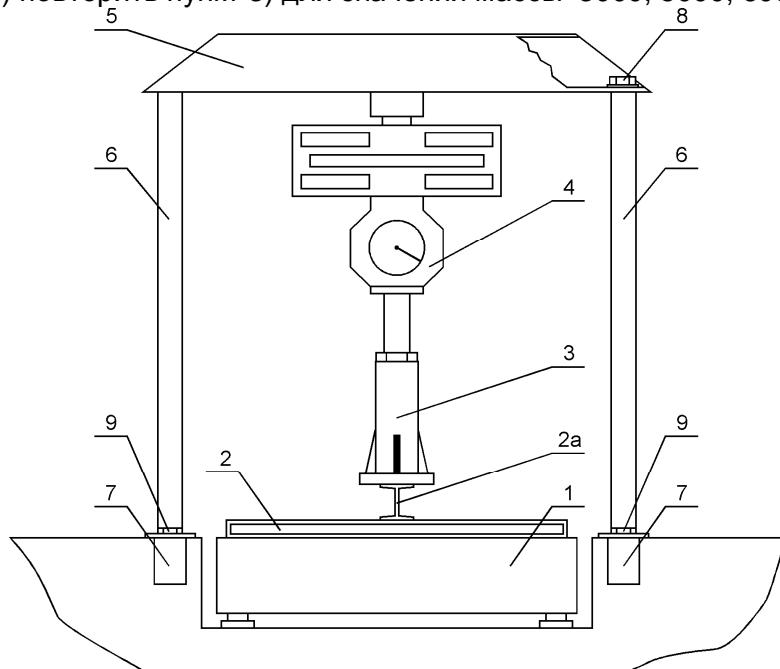
1 – Роликовая установка; 2 – Продольная балка; 2а – Поперечная балка;
