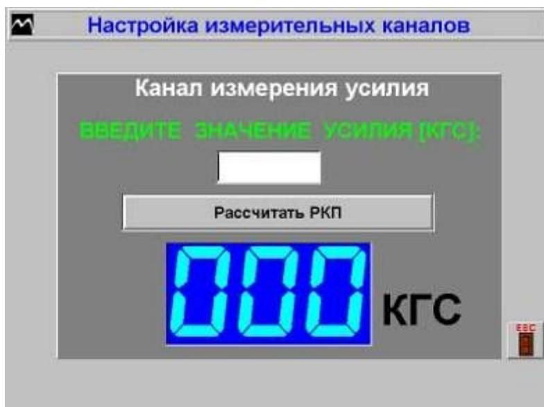
в) вращая рукоятку нагрузить датчик усилием 20 кгс (196 Н) и выдержать датчик под нагрузкой в течение 2 минут. Нужное значение устанавливается по показаниям образцового динамометра;
