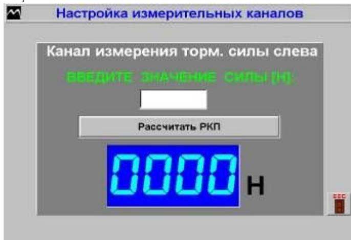
и) вращая винт нагрузки и контролируя задаваемую нагрузку по индикатору динамометра, задают усилие, соответствующее тормозной силе, равной 4000 Н (см. таблицу 3).
