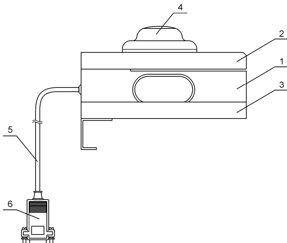
1 - Корпус; 2 – Верхняя пластина; 3 – Нижняя пластина; 4 – Кнопка;
