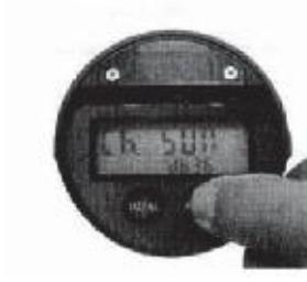
Нажмите “Reset” в течение трех секунд, и на дисплее отобразится контрольная сумма.
