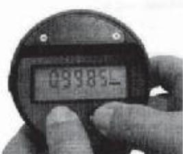
Нажмите по три раза “Total” и “Reset” для перехода в режим программирования. Единица измерения “L” (литр) мигает и может быть изменена на L (литр) GAL (галлон), QT (кварты), или PT (пинта) путем нажатия “Reset”. Нажмите “Total” для подтверждения новой единицы измерения.
