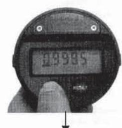
Нажмите “Total” один раз для изменения коэффициента коррекции. Изменяемая цифра мигает и может быть установлена посредством кнопки “Reset”. Для изменения следующей цифры нажмите “Total”.
