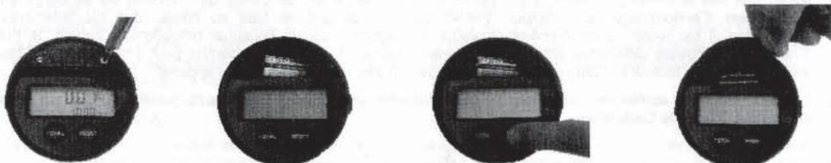
1. Снимите крышку аккумуляторного отсека
