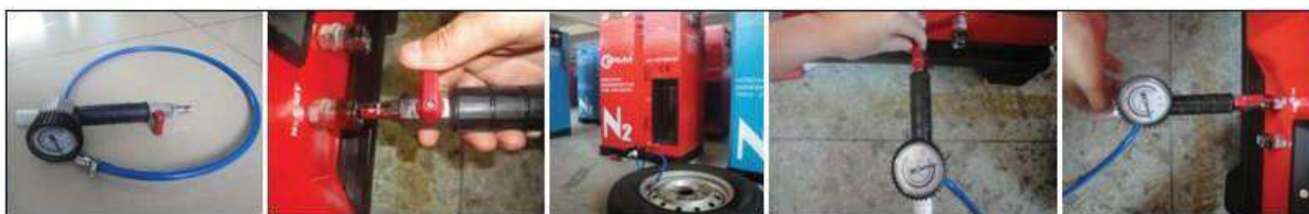
Рис. 4 Вакуумирование и накачка
