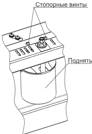
Рисунок 2.3 - Перевод Устройства в транспортное положение
