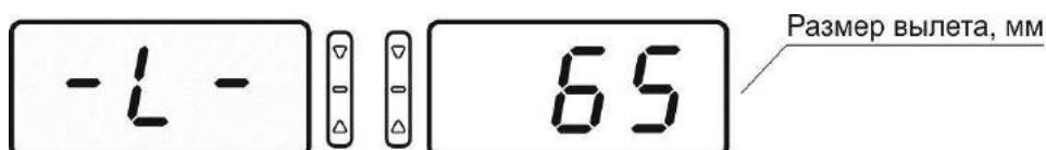
Рисунок 7.2 – Показания индикаторов во время пользования электронной линейкой для измерения дистанции (измеритель диаметра выключен)
