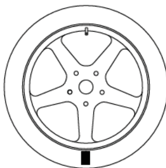
Рис. 5.6 - Маркировка шины на 180° относительно клапана
