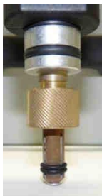
Медный наконечник с 4 прорезями для приваривания шпилек M4 (Ø4 мм)
