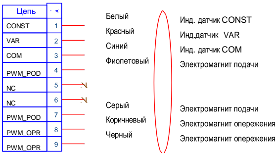
Рисунок 15. Схема распайки разъема ТНВД тип 2
