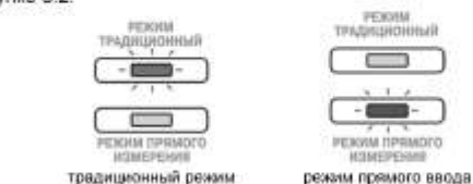
Рисунок 6.2 – индикация режимов ввода параметров колеса
