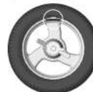
Рисунок 6.24 – Груз установлен в положение «12 часов»
