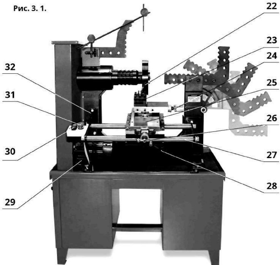
**22** – ручка крепления резцодержателя; **23** – резцодержатель; **24** – винт продольной подачи; **25** – суппорт; **26** – винт поперечной подачи; **27** – направляющие каретки; **28** – ручка крепления каретки; **29** – электродвигатель, привода шпинделя; **30** – кнопки «Пуск/Стоп» привода шпинделя; **31** – кнопка аварийной остановки; **32** – кронштейн токарного модуля;
