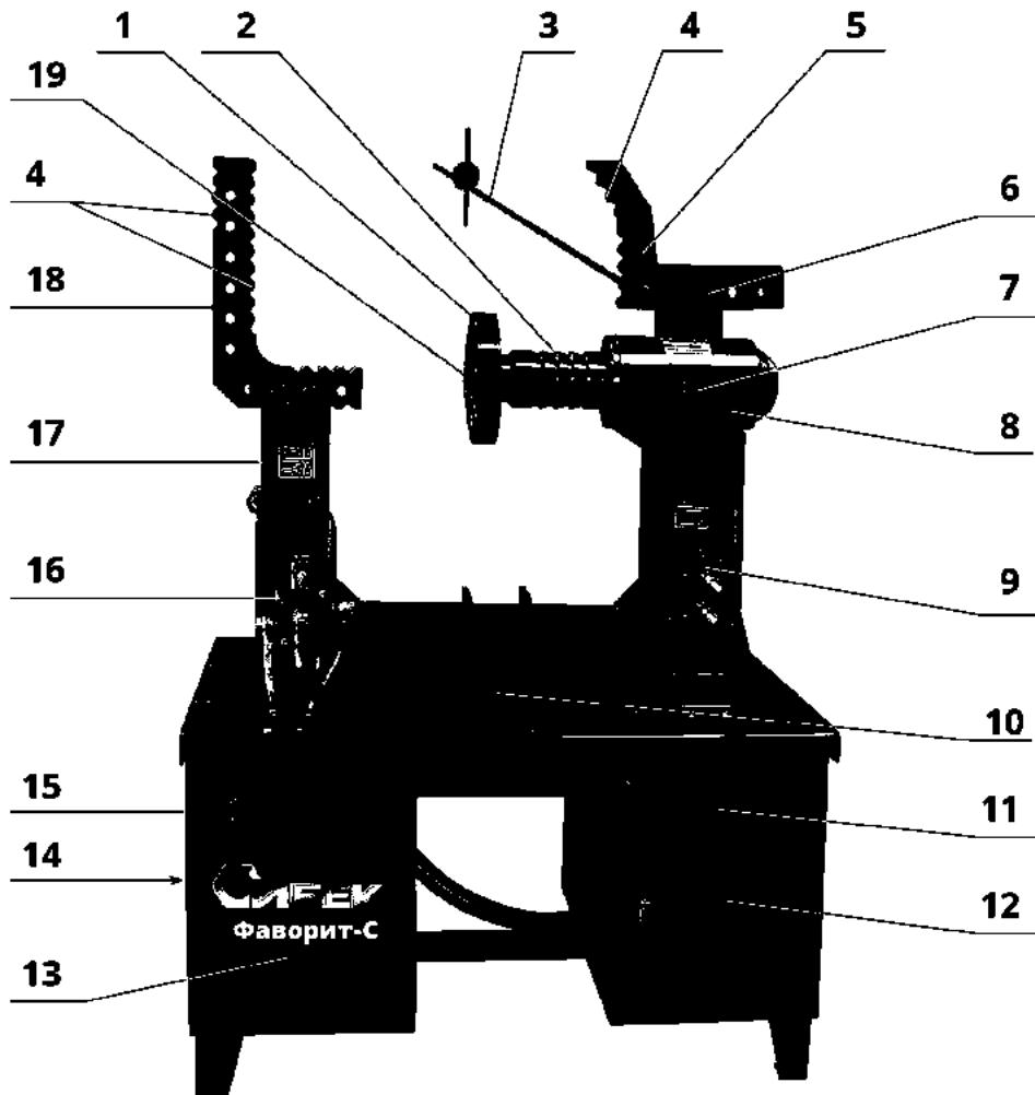
1 - планшайба; 2 - вал шпинделя с опорными выступами; 3 - указатель биения; 4 - опорные выступы; 5 -правый упор; 6 - фиксатор; 7 - стопор; 8 - шпиндельный узел; 9 - гидроцилиндр; 10 - мобильный кронштейн; 11 - рукава высокого давления; 12 - инструментальный шкаф; 13 - корпус стендса; 14 - декоративная панель; 15 - кнопка «Пуск/Стоп» гидравлики; 16 - гидрораспределитель; 17 - откидной кронштейн; 18 - левый упор; 19 - центрующая шайба.
