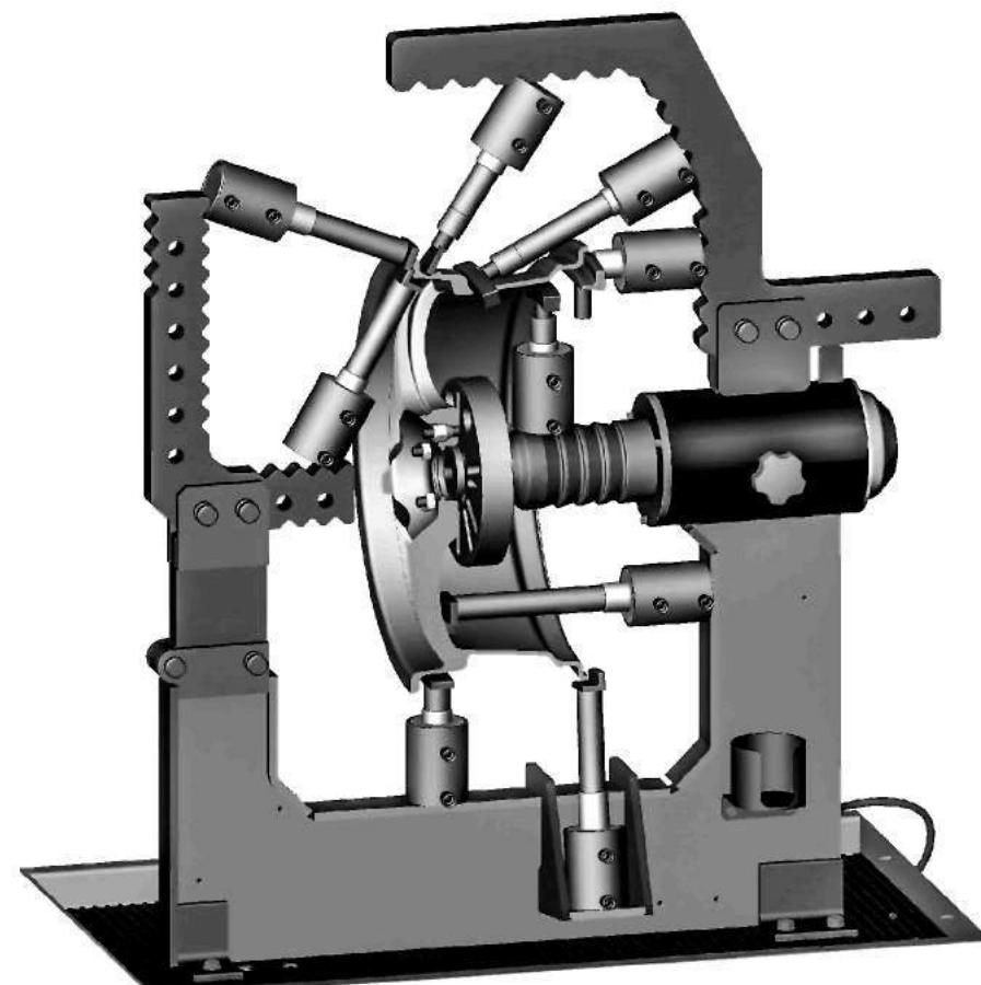
*Установку рабочего гидроцилиндра проводите в соответствии с рекомендуемыми положениями Рис. 4.*
