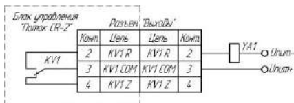
Рисунок 7.31 - Управление шторкой-задвижкой. Схема 2
