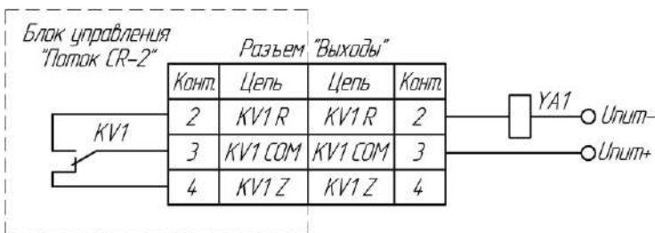
Рисунок 4.14 - Управление шторкой-задвижкой. Схема 2
