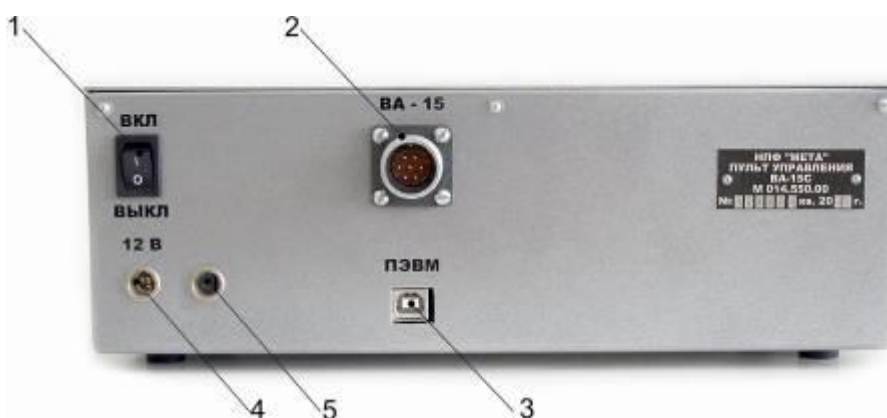
Рисунок 3а – Терминал управления весами. Вид спереди
